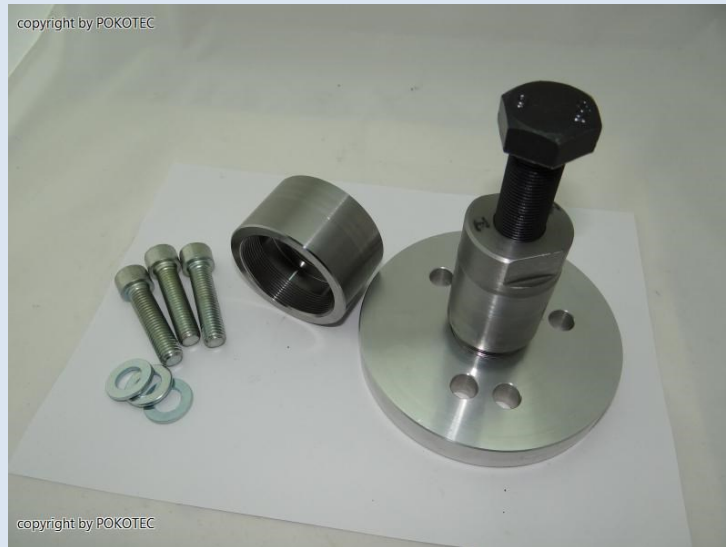
Abzieh-Werkzeuge für das Polrad, Schwungmasse und Vape Zündung
