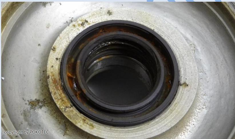
Stützlager hinter den Wellendichringen
